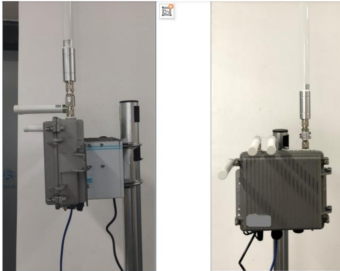
Formas de instalar la pasarela con el aro
