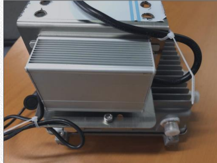
Asegurar el cable con una brida
